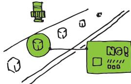
製造ラインの検査工程にカメラを設置することでAIがキズや欠け、変形などを自動的に検知します。
