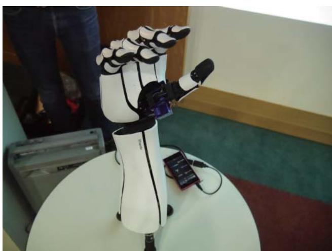
スマホを活用した筋電義手 (外装は3Dプリンターで制作し取替え可能)
