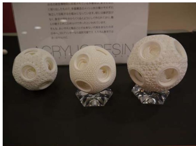
中国の伝統工芸を模した13層の多層球 (3Dプリンターで制作)
